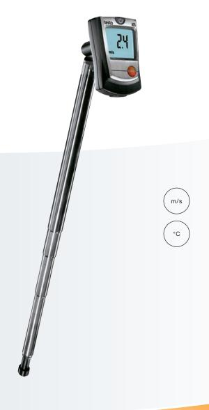
Le testo 405 est un anémomètre thermique. Il permet une mesure précise de l'écoulement d'air, du débit volumétrique et de la température. Avec son télescope (extensible jusqu'à 300 mm), cet appareil de mesure convient tout particulièrement pour les mesures d'écoulement dans les canalisations. Le télescope peut être placée idéalement dans les canalisations grâce au support fourni.
