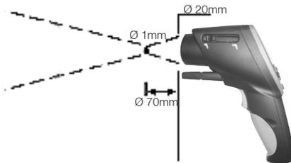
**i** Si la distance de l'objet à mesurer est  $>250\text{mm}$ , il faut commuter l'optique.
