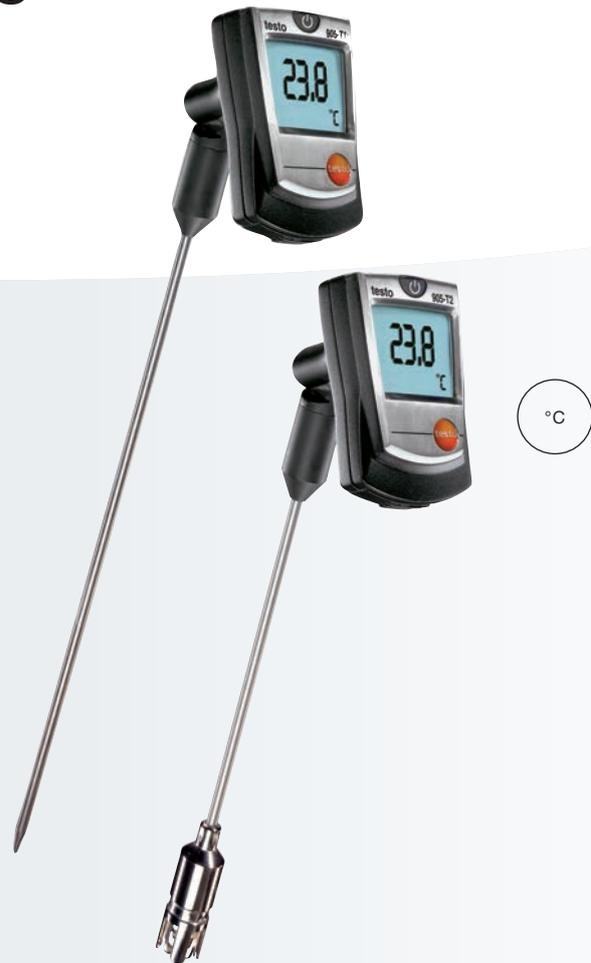
El testo 905-T1 es un termómetro de penetración particularmente rápido con un amplio rango de medición de entre -50 y +350 °C, aunque brevemente también puede medir hasta +500 °C (entre 1 y 2 minutos). El instrumento está equipado con un sensor profesional industrial (termopar tipo K). Especialmente en la zona alta del rango de medición muestra una excelente precisión.
