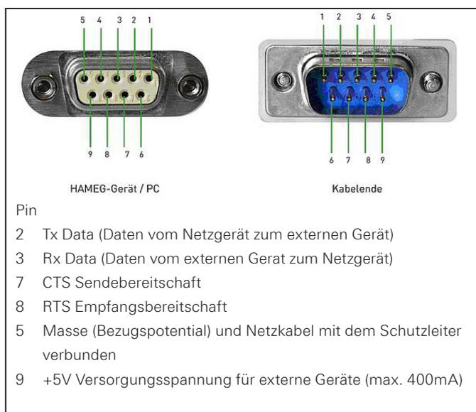
Abb. 8.1: Pinbelegung der RS-232 Schnittstelle
