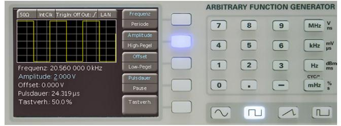
Abb. 4.5: Anzeige für die geänderte Amplitudeneinstellung
