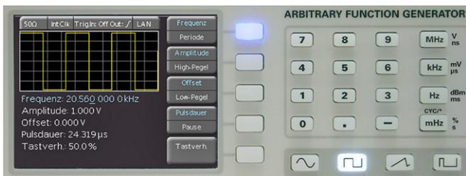
Abb. 4.4: Anzeige für die geänderten Einstellungen
