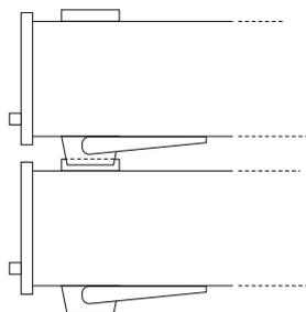
Die vorderen Gerätefüße werden wie in Abb. 1 aufgeklappt. Die Gerätefront zeigt dann leicht nach oben (Neigung etwa 10°). Bleiben die vorderen Gerätefüße eingeklappt (siehe Abb. 2), lässt sich das Gerät mit weiteren ROHDE & SCHWARZ Geräten sicher stapeln. Werden mehrere Geräte aufeinander gestellt, sitzen die eingeklappten Gerätefüße in den Arretierungen des darunter liegenden Gerätes und sind gegen unbeabsichtigtes Verrutschen gesichert (siehe Abb. 3). Es sollte darauf geachtet werden,
