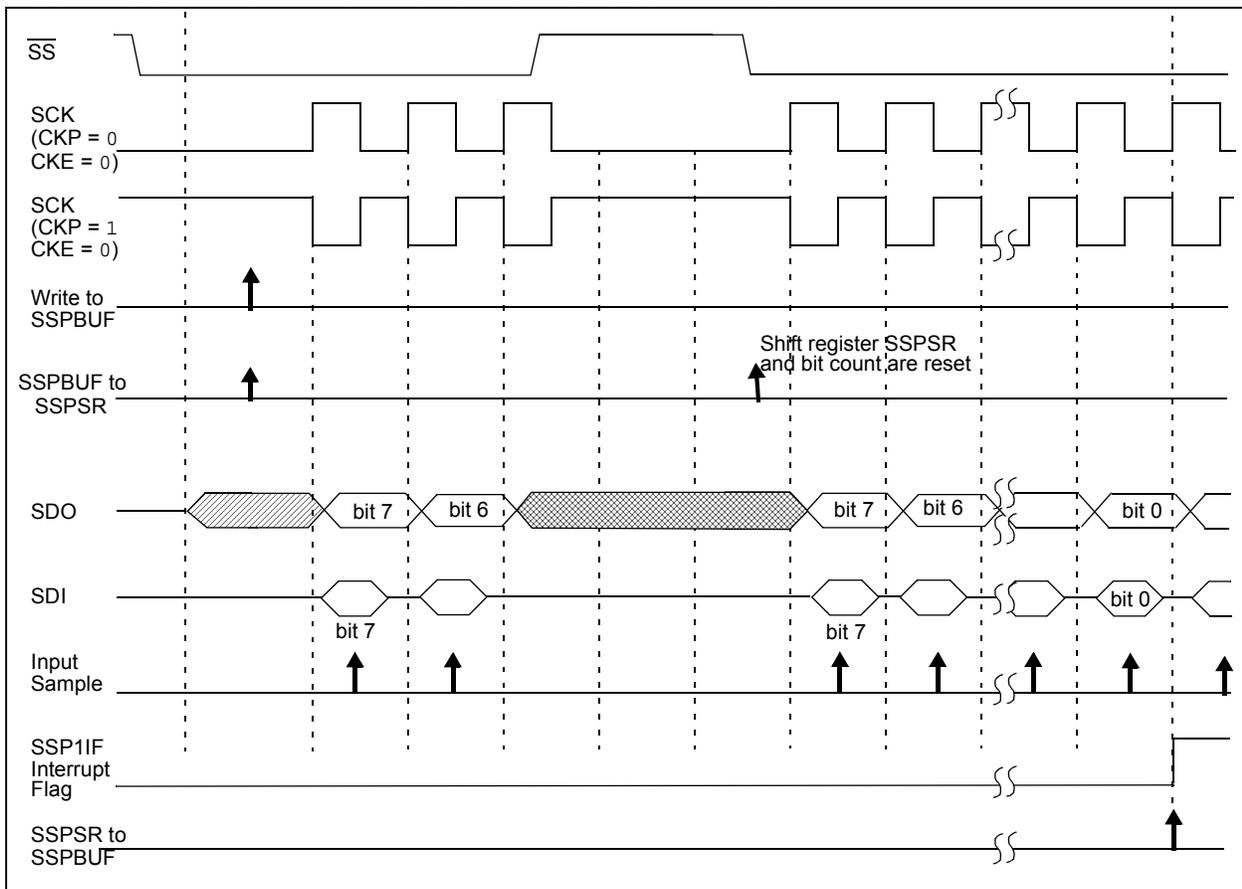
**FIGURE 20-9: SPI MODE WAVEFORM (SLAVE MODE WITH CKE = 0)**
