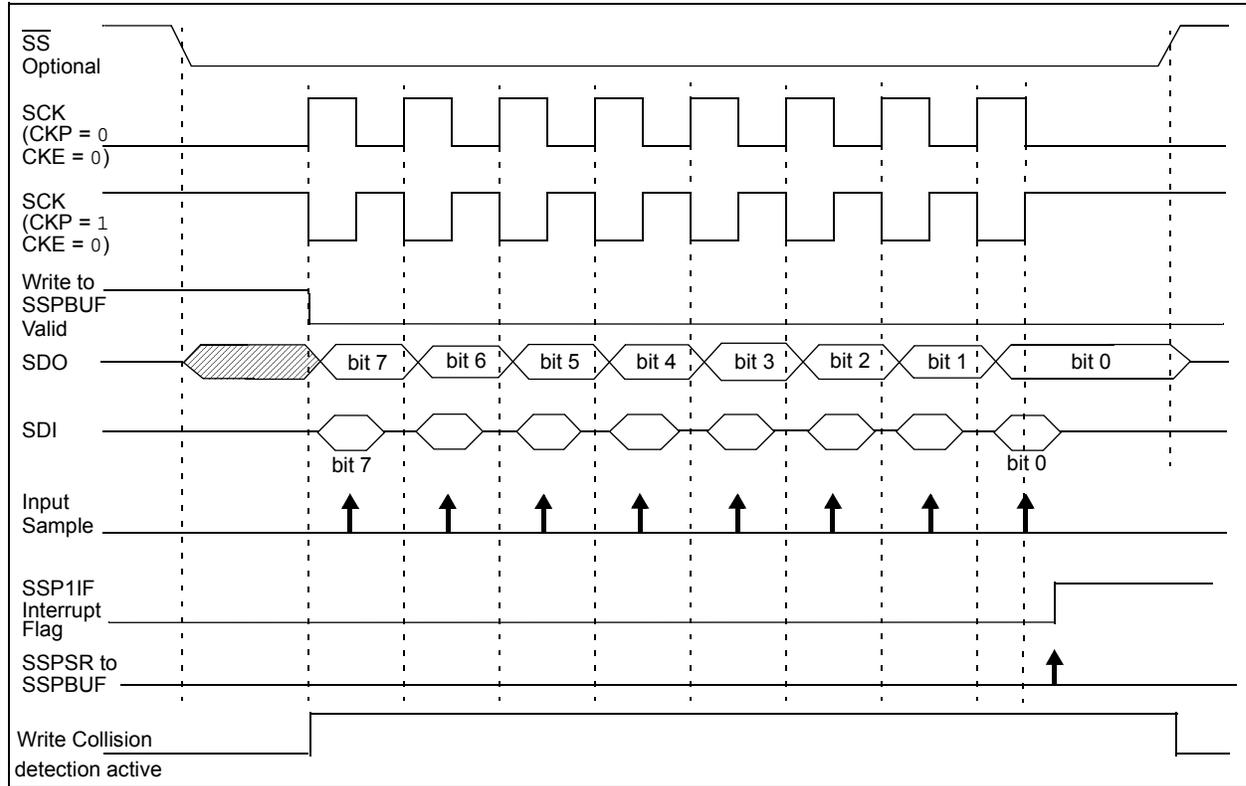
**FIGURE 20-10: SPI MODE WAVEFORM (SLAVE MODE WITH CKE = 1)**
