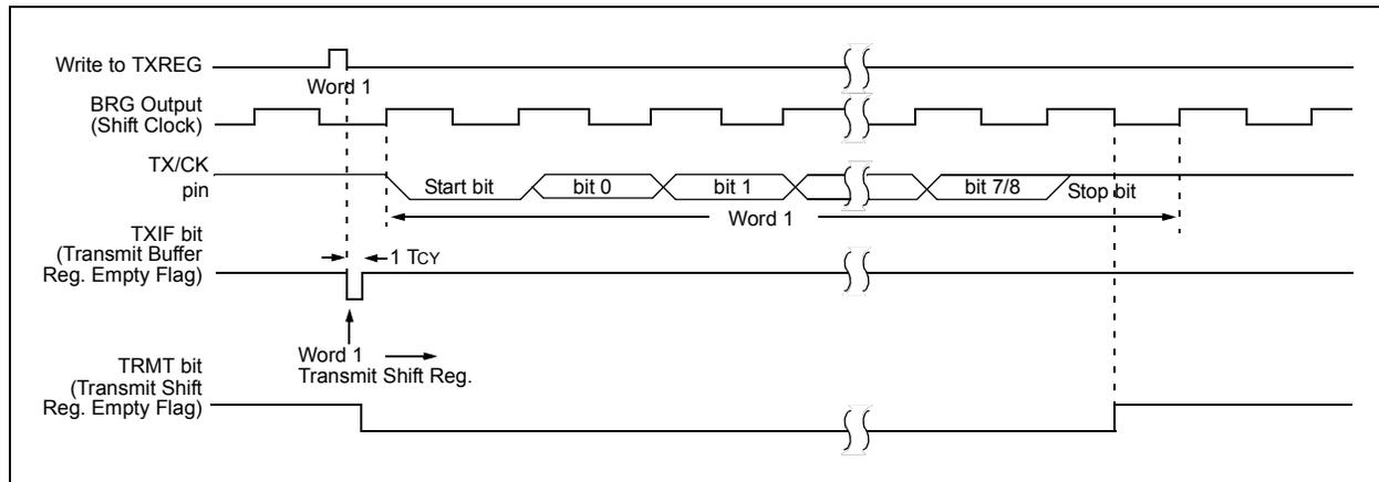
**FIGURE 21-4: ASYNCHRONOUS TRANSMISSION (BACK-TO-BACK)**
