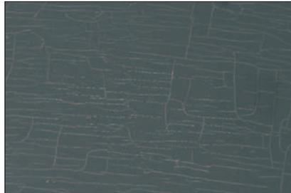
Das Gefüge ist durchgängig durch die UV-Strahlung geschädigt.
