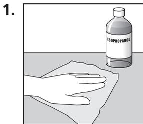
Die Oberflächen müssen trocken, frei von Staub, Öl, Oxiden, Trennmitteln und anderen Verunreinigungen sein. Die zu verklebende Oberfläche ist mit einem sauberen Tuch und Isopropanol/ Wasser (50/50) zu reinigen. Bei Verwendung anderer geeigneter Reinigungsmittel ist darauf zu achten, dass die Oberfläche nicht angegriffen wird und keine Rückstände hinterlassen werden.
