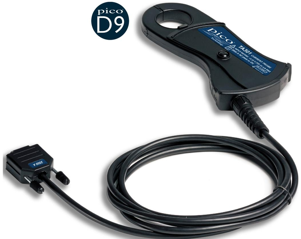
TA301電流プローブは、帯域幅20 kHzのスイッチレンジ200/2000 A AC/DCプローブで、非絶縁導体で150 V CAT IIの定格となっています。
