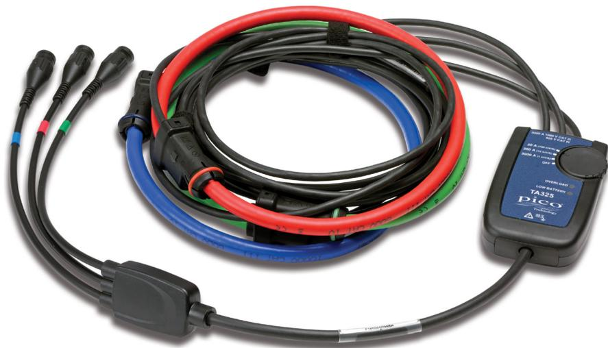
TA325は、帯域幅10 Hz~20 kHzのスイッチレンジ30/300/3000 A AC RMSプローブで、非絶縁導体で1000 V CAT IIIの定格となっています。三相AC電流の測定に適したこのプローブには、3つのセンサーコイル、スコープ接続リードがついており、PicoScopeソフトウェアのチャンネルA、B、Cに対応するように色分けされています。通常のバッテリー寿命は1000時間です。
