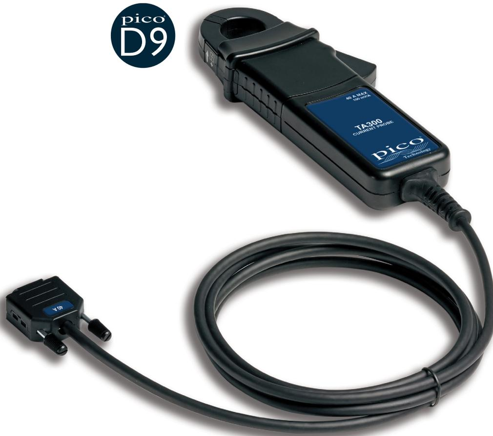
TA300電流プローブは、帯域幅100 kHz、40 A AC/DCのプローブです。これは、非絶縁導体で300 V CAT IIIまでの使用の定格となっている、より小さい電流用の高精度プローブです。
