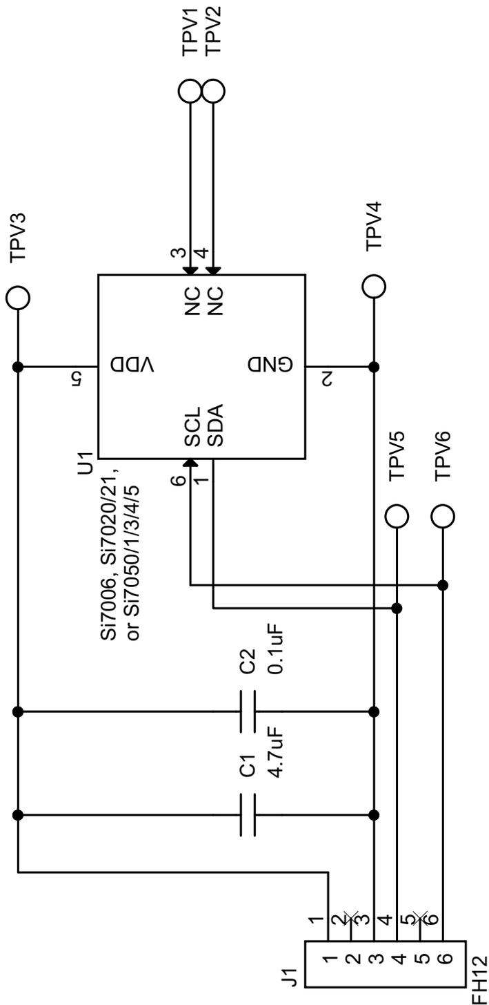
Figure 16. Si7006, Si7020/21, or Si7050/1/3/4/5 EB Schematic
