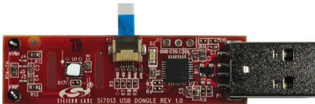
Figure 1. Si7013USB-DONGLE
