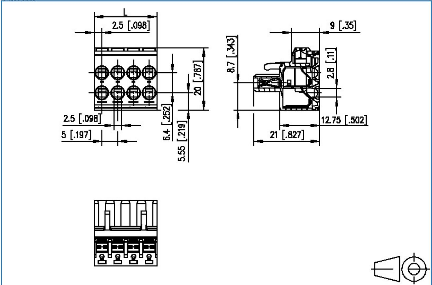
$$L = (\text{Nbre de pôles} - 1) \times \text{pas} + 5 [0.197]$$
