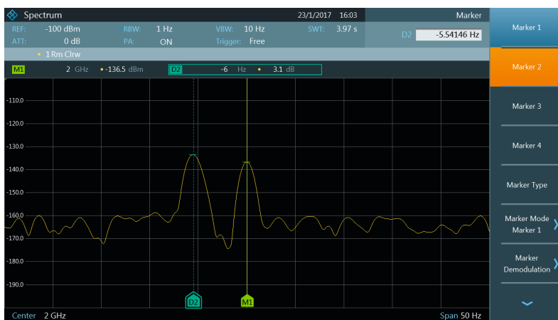
R&S®FPC-B22 : haute sensibilité avec largeur de bande de résolution de 1 Hz.
