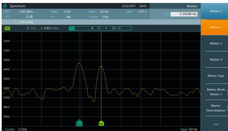
R&S®FPC-B22: alta sensibilidad con ancho de banda de resolución de 1 Hz.
