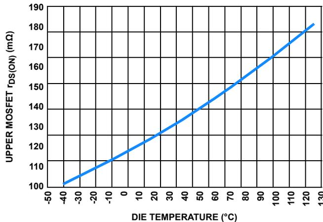
FIGURE 17. UPPER MOSFET r<sub>DS(ON)</sub> (mΩ) OVER-TEMPERATURE
