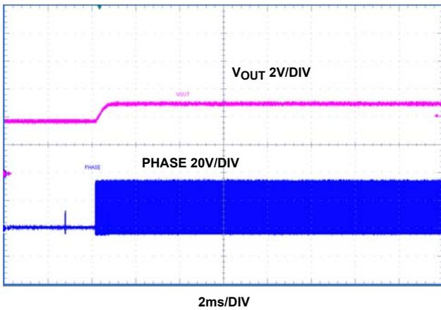
FIGURE 20.  $V_{IN}$  36V, PREBIASED START-UP
