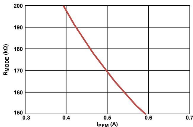
FIGURE 31. R<sub>MODE</sub> vs I<sub>PFM</sub>
