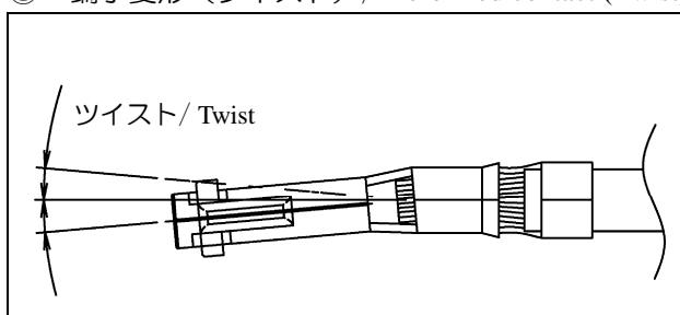
工具の調整状態や、工具への端子のセット状態、端子の取り扱いにより発生する事があります。ツイストが著しいと、ハウジングへの挿入が行えない事があります。
