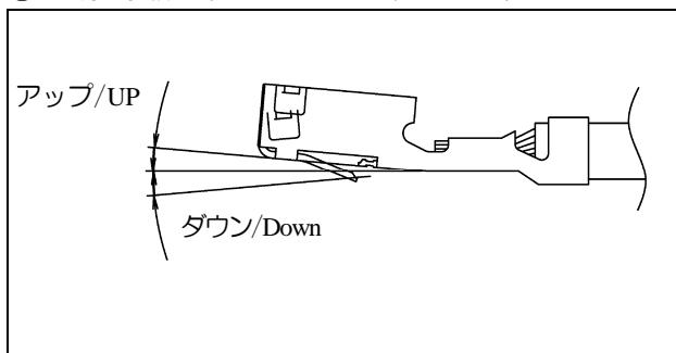
工具の調整状態や摩耗、端子の工具へのセット状態、端子の取り扱いにより発生する事があります。ベントアップ、ダウンが著しいと、ハウジングへの挿入が行えない事があります。
