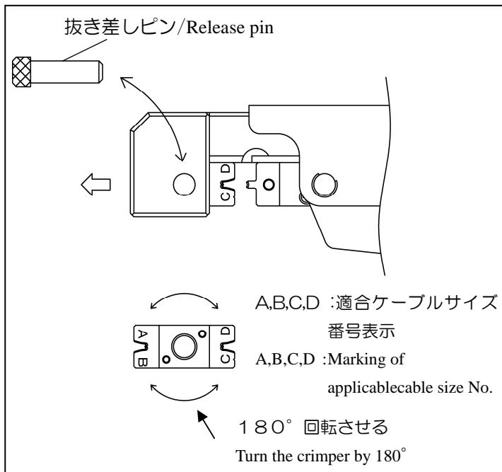
1) 圧着工具ヘッド部にある抜き差しピンを引き抜いてください。
