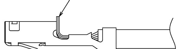
電線のストリップ寸法が不適切だったり、工具への電線のセットの仕方により発生する事があります。突き出しが長過ぎる事によりコンタクトの接触障害となったりハウジングへの挿入不完全となる恐れがあります。
