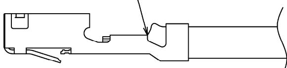
電線のストリップ寸法が不適切だったり、工具への電線のセットの仕方により発生する事があります。
