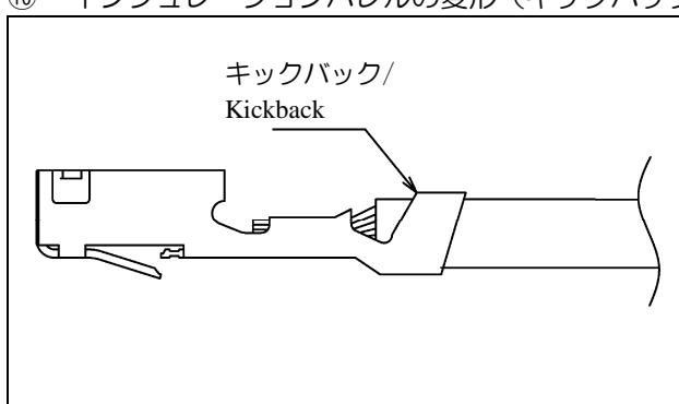
工具に適合しない電線を使用した時に発生する事があります。
