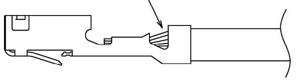
電線のストリップ寸法が不適切だったり、工具への電線のセットの仕方により発生する事があります。
