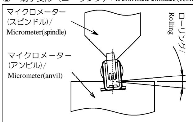
工具の調整状態や歯型の摩耗、工具への端子のセット状態、端子の取り扱いにより発生する事があります。ローリングが著しいと、ハウジングへの挿入が行えない事があります。
