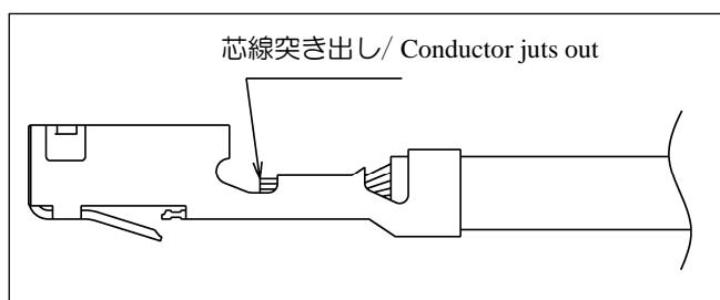
適正なストリップ長さ：圧着した際、ワイヤーバレル先端から芯線が突き出しており、また被覆がインシュレーションバレルより引っ込んでいたりワイヤーバレル内に入り込まない状態であること。
