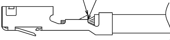
工具の調整状態や、工具への端子のセットの仕方により発生する事が有ります。ベルマウスが無かったり大き過ぎる事により、芯線の断線や引っ張り強度の不足、電気的接続の不安定となる恐れがあります。
