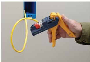
4. Veillez à ce que la prise soit insérée à fond et solidement dans le logement pour prise, les fentes IDC devant faire face aux lames.
