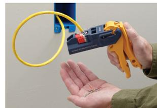
6. Les fils sont posés et coupés pour un raccordement solide.
