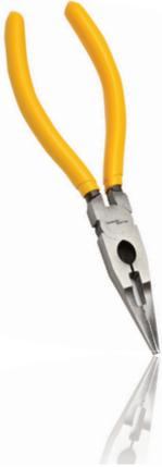
Cet outil quatre en un breveté à bec effilé combine un instrument à sertir pour connecteurs UR/UY/UG et des pinces à bec effilé, ce qui signifie que vous avez un outil de moins à porter à la ceinture. Les mâchoires à sertir sont de forme carrée pour une connexion ferme. La surface rainurée des pinces permet une meilleure prise des fils et comporte une pince à dénuder et un coupe-fil intégrés.
