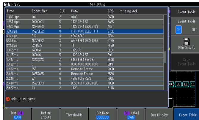
Ereignistabelle mit Auflistung der dekodierten Kennung, DLC, DATEN und CRC für jedes CAN-Paket in einer umfangreichen Erfassung.
