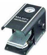
Das Fußventil-Dosiersystem der Serie 924-DFV bietet eine preiswerte Dosiermöglichkeit in der Produktion. Fußpedal, Druckregler, Manometer und ein schnelles Dreiwegeventil sind in das Gehäuse des Fußventils integriert. Bei Bedarf kann das Ventil am Boden befestigt werden. Dosiermenge und Zeit werden vom Anwender über das Fußpedal geregelt.
