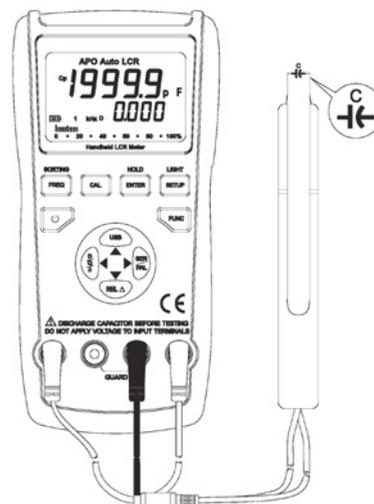
**Nota:** i condensatori devono essere completamente scaricati prima di effettuare la misurazione.
