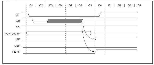
FIGURE 5-13: PARALLEL SLAVE PORT READ WAVEFORMS
