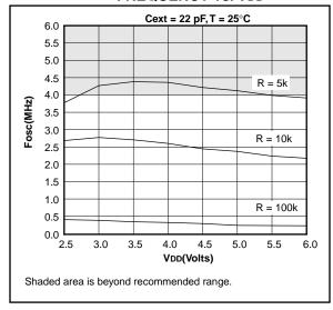
FIGURE 24-6: TYPICAL RC OSCILLATOR FREQUENCY vs. VDD
