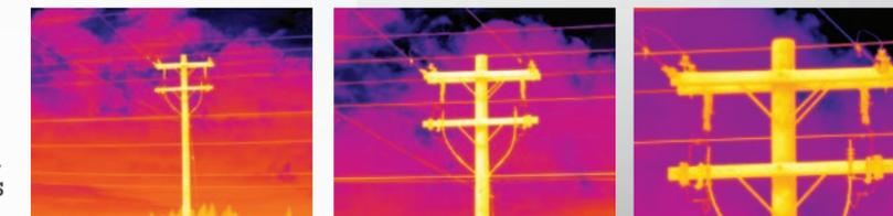
Standard (à gauche), téléobjectif 2x (au centre) et téléobjectif 4x (à droite)—observez le niveau adéquat de détails infrarouges essentiels
