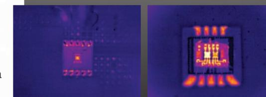
Standard (à gauche) et objectif macro 25 microns (à droite)—observez les détails d'objets minuscules
