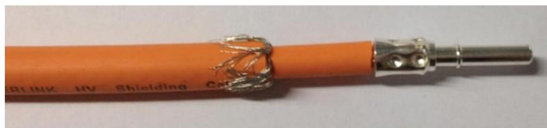
4. 将金属屏蔽、橡胶垫、扣盖依次套在线缆上。
