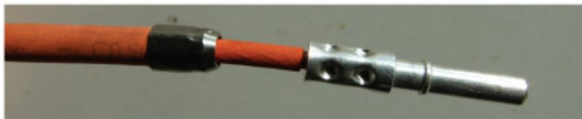
6. 将压好端子的电线（两条）插入连接器。
