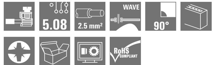
Leiterplatten-Klemme mit Druckbügelanschluss im Raster 5,00 und 5,08 mm, Leiterabgangsrichtung in 90° Ausführung. Für Leiterquerschnitte bis 2,5 mm<sup>2</sup> geeignet.
