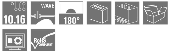
Einreihige Hochstrom-Stiftleiste, pulverlustfrei anreihbar oder mit patentiertem Flansch zur schnellen, werkzeuglosen Verriegelung. Höchste Bedienungs- und Betriebssicherheit durch 100% fehlstecksicheres Steckgesicht, einzigartige Kodiervielfalt, Zusatzbefestigung und integrierbare Positionierhilfe. Stiftlänge mit 3,5 mm optimiert für den Wellenlötprozess, Steckrichtung 180° zu den Lötstiften.
