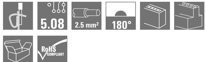
Connecteurs femelles pour le raccordement du conducteur en technique de raccordement à ressort, orientation de sortie à 180°. Les connecteurs femelles disposent d'espace pour les marquages et peuvent être codés.
