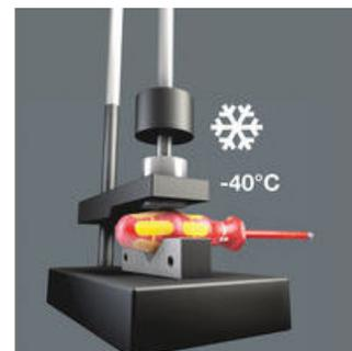
Le contrôle de la résistance au choc à froid (à  $-40^{\circ}\text{C}$ ) garantit la sécurité même dans les conditions d'utilisation extrêmes.
