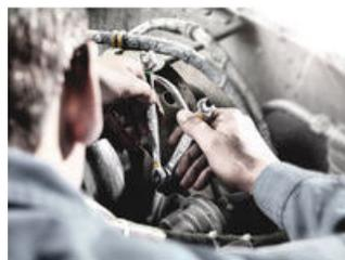
La double fourche Joker se prête idéalement au (contre-)serrage de vis et d'écrous.
