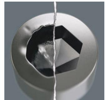
Le problème des vis à six pans creux tient à la minceur des surfaces d'appui sur lesquelles s'opère la transmission de la force depuis l'outil. Résultat : la tête de vis peut être endommagée. Les outils Hex-Plus possèdent des surfaces d'appui plus larges qui empêchent ce problème. Avec la possibilité, simultanément, de transmettre des couples jusqu'à 20 % supérieurs. Bon à savoir: les outils Hex-Plus s'utilisent sur toutes les vis à six pans creux standard !
