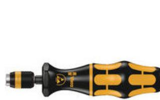
Ces outils sont idéaux pour toutes les applications où l'on a constamment besoin du même couple et d'une précision à la fois élevée et répétitive. La valeur du couple peut être modifiée à l'intérieur de la plage de mesure. Retirer pour ce faire le capuchon situé en haut du manche et actionner l'écrou de réglage au moyen d'une clé à douille.
