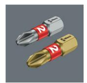
BTH- (harte Ausführung) und BTZ-Bits (zähharte Ausführung) haben eine angelassene BiTorsion-Zone, wodurch die Härte des Schaftes um ca. 20 % gegenüber der Abtriebsspitze reduziert wird. Dadurch wird das Verwinden der Bitspitze bei auftretenden Belastungsspitzen vermieden, was die Lebensdauer des Bits noch weiter erhöht.
