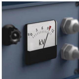
Die Prüfung des Werkzeugs auf Durchschlagsfestigkeit bei 10.000 Volt gibt dem Anwender die beruhigende Gewissheit, dass sein Schraubendreher auf seine wichtigste Eigenschaft, die Isolation, geprüft worden ist. Wera VDE-Schraubendreher werden Stück für Stück dieser Prüfung unterzogen. Sicheres Arbeiten bis 1.000 Volt ist somit garantiert.
