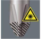
Mittels eng fokussiertem Laserlicht eine scharfkantige Oberflächenstruktur erzeugt. Die Laserbehandlung bewirkt eine Härte der Spuren von bis zu 1000 HV 0,3. Wera Lasertip krallt sich Schraubenkopf fest und verhindert das Herausrutschen aus dem Schraubenkopf. Bei Schlitz, Phillips und Pozidriv.
