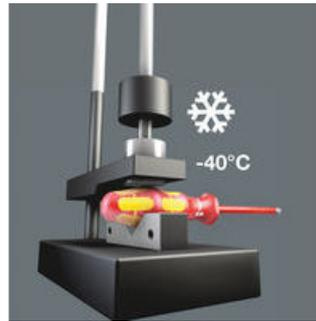
Auch bei extremen Einsatzbedingungen ist durch die geprüfte Kaltschlagfestigkeit bei -40 °C die Sicherheit gewährleistet.
