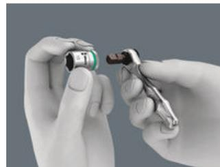
Bits und Nüsse. Bits kann ich direkt aufstecken. Ich kann auch erst einen Halter einstecken, der dann den Bit führt. Dieser dient dann ebenfalls als Verlängerung mit freilaufender Führungshülse. Für Nüsse brauche ich einen Adapter 1/4" Sechskant auf Vierkant, z. B. Wera 870/1 (im Bit-Check und bei der einzelnen Bit-Ratsche im Set enthalten).
