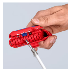
Afisolering af et koaksial-kabel
