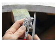
Almindelig skruenøgle: Kantpresning medfører beskadigelse
