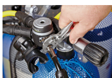
Pince-clé : pression superficielle sans jeu, pas d'endommagement des arêtes
