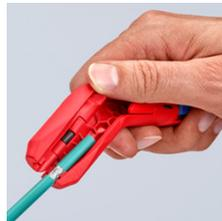
Spelare un cavo per trasmissione dati
