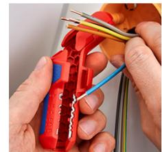
Spelatura isolamento di singoli conduttori
