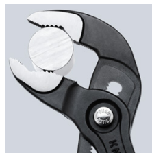
I denti contrari al senso di rotazione provocano un effetto autoserrante ed impediscono lo scivolamento sul pezzo.
