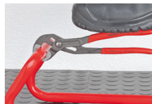
I denti contrari al senso di rotazione provocano un effetto autoserrante ed impediscono lo scivolamento sul pezzo.
