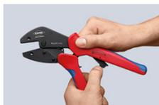
Posizionare e sostituire: azionare la leva di posizionamento per fissare le ganasce in parallelo
