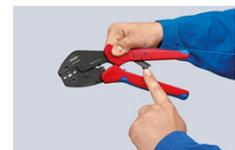
Sbloccare la leva di posizionamento e chiudere la pinza - pronta per l'uso
