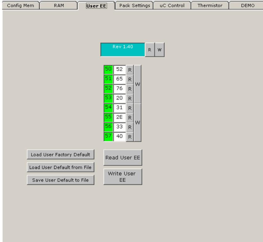
**FIGURE 28. ISL94203 GUI - USER EEPROM TAB**
