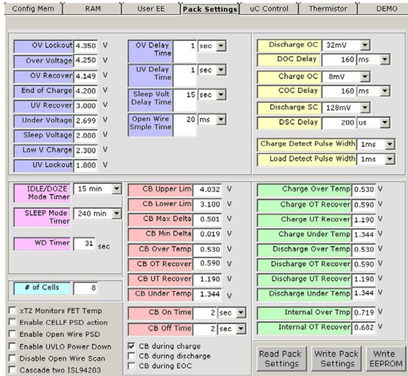
**FIGURE 29. ISL94203 GUI - PACK SETTINGS TAB**
