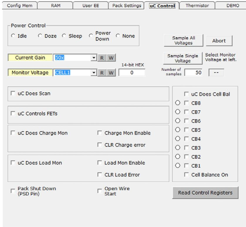
**FIGURE 39. ISL94203 GUI -  $\mu\text{C}$  CONTROL TAB**
