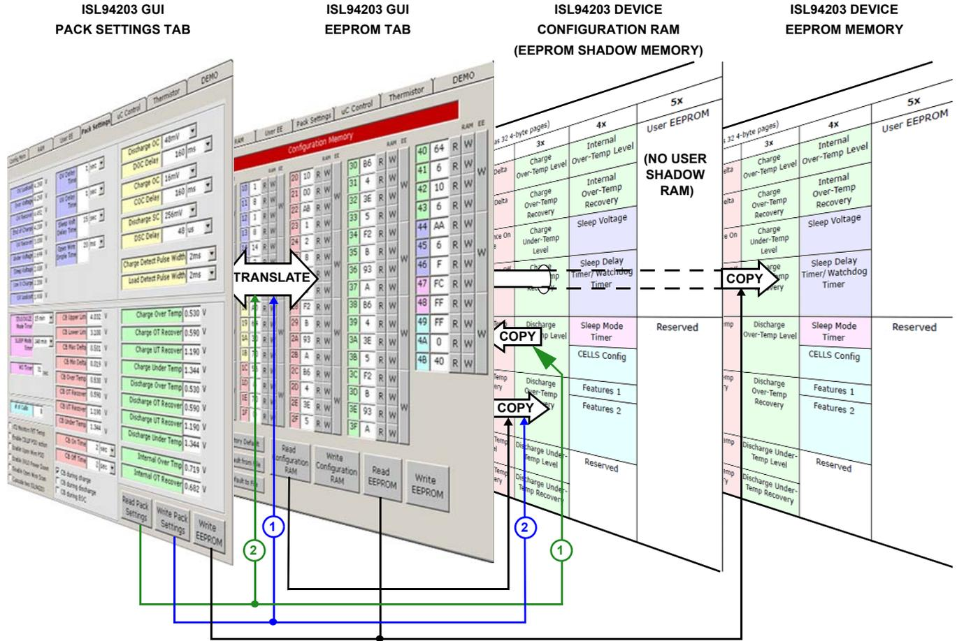
FIGURE 30. ISL94203 GUI PACK SETTINGS TAB MEMORY OPERATIONS
