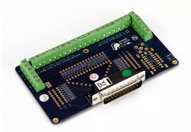
Inoltre, l'ADC-24 dispone di quattro canali di ingresso/uscita digitali configurabili, che possono essere utilizzati per controllare allarmi o altri dispositivi. La flessibilità di ADC-20 e ADC-24 consente di utilizzare questi registratori di dati di precisione come un avanzato sistema di acquisizione di dati multicanale con un basso costo per canale.
