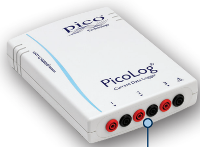
4 mm 插座可最多使用三个电流卡夹
