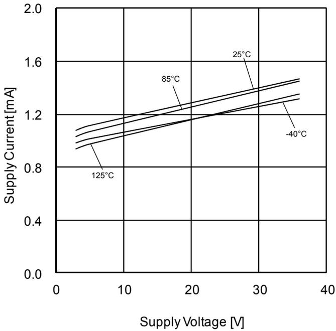
Figure 30. 回路電流－電源電圧特性
