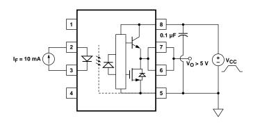
Figure 21.  $I_{\text{FLH}}$  Test Circuit.
