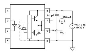
Figure 19. V<sub>OH</sub> Test Circuit.
