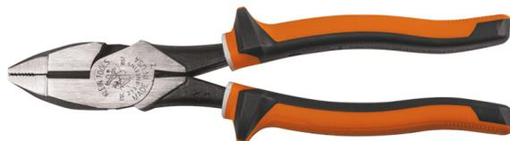
Klein Tools isolierte Seitenschneider mit hoher Hebelwirkung für Elektriker sind für 1000 V ausgelegt und VDE-zertifiziert für hohe Sicherheit am Arbeitsplatz. Das mehrfarbige, schlanke Design mit kleinem Daumenschutz erleichtert die Handhabung und Aufbewahrung. Die dreiteilige Isolierung enthält eine weiße Unterbeschichtung, die vor beschädigter Isolierung warnt.
