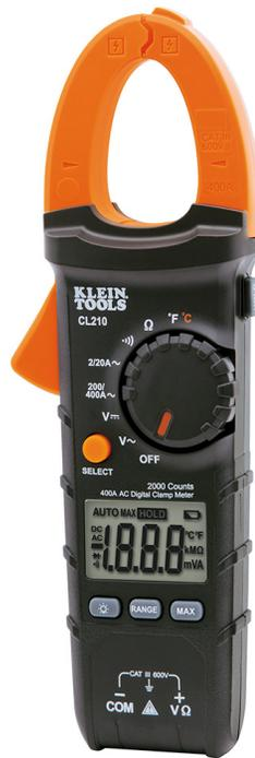
Klein Tools CL210 ist eine digitale Stromzange mit automatischer Bereicheinstellung zur Messung von AC-Strom über die Zange, AC/DC-Spannung, Widerstand und Durchgang über Messleitungen und Temperatur über das Thermoelement. Exklusiv von Elektrikern für Elektriker entwickelt. Viele Jahre der Feldforschung und die zahlreichen Anregungen von Elektrikern aus ganz Amerika haben die Entwicklung unserer Messgeräte mit den vielen innovativen, zeitsparenden Funktionen inspiriert.
