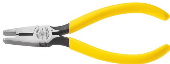
Zum Crimpen und Einsetzen von Kabeln in UG-, UR- und UY-Steckverbinder. Gekrümmte Griffe für bessere Kontrolle. Induktionsgehärtete Seitenschneider mit langer Lebensdauer. 11/16 Zoll Backenbreite. Scotchlok® ist eingetragene Marke von 3M.
