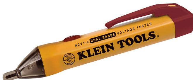
Dieser berührungslose Spannungsprüfer mit zwei Messbereichen erkennt automatisch Niederspannung und Normalspannung. Eine helle, grüne LED zeigt an, dass das Prüfgerät funktioniert und dient gleichzeitig als Arbeitslicht. Das Licht blinkt rot und zwei verschiedene Warntöne erklingen, wenn Nieder- bzw. Normalspannung erkannt wird.
