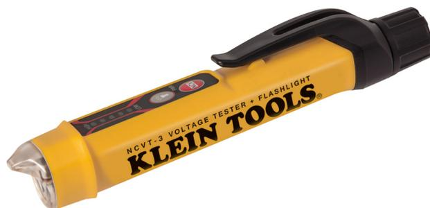
Der NCVT-3 ist ein berührungsloser Spannungsprüfer mit integrierter Leuchte. Der Spannungssensor erkennt 12 bis 1000 V AC und zeigt das Vorhandensein von Spannung in einadrigen und mehradrigen Kabeln, Leistungsschaltern, Leuchten, Schaltern, Steckdosen und Drähten sowie AC-Spannung in Türklingeln, Thermostaten, Niedervolt-Beleuchtungen und Bewässerungsanlagen an. Sendet sowohl visuelle als auch akustische Signale aus. Der NCVT-3 ist für jeden Arbeitsplatz ausreichend robust.
