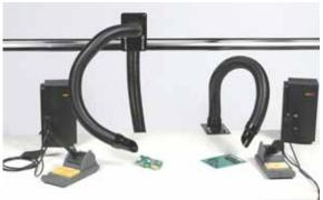
Die **BVX-Arme** (50 mm Ø) stellen eine preiswerte Lösung dar. Sie vereinen gute Absaugleistung mit großer Flexibilität. Aufgrund des spiralförmigen Aufbaus der Arme können diese durch Drehen verfestigt und präzise positioniert werden. Über einen Y-Adapter können zwei BVX-Arme an einen Lufteinlass der MFX-Systeme angeschlossen werden. So ist es möglich, bis zu acht Arbeitsplätze mit einem Absaugsystem zu verbinden.
